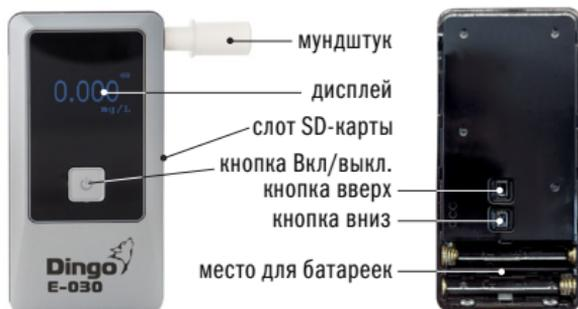
На лицевой панели анализатора расположены кнопка включения/выключения, и информационный дисплей.
