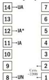
Рис. 7 – Клеммы подключения. Тип корпуса P77
