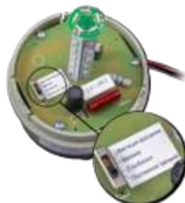
Рис. 1 – Платы управления со светодиодами. Переключатель режимов
