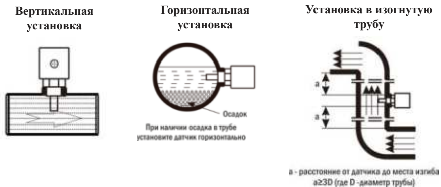
Рис. 2 – Схема подключения
