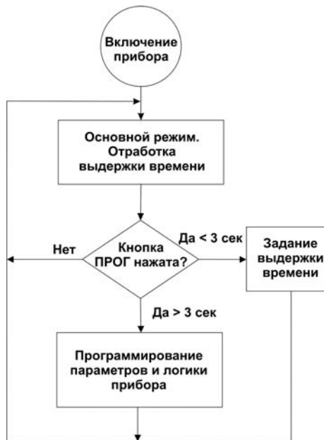
Рис. 4. Блок-схема доступа к элементам меню прибора
