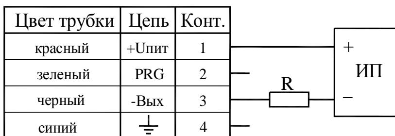
Рисунок Б.3 – Схема подключения кабеля преобразователей гидростатического давления
