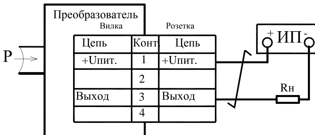
Рисунок Б.1 – Схема подключения преобразователей общепромышленного исполнения
