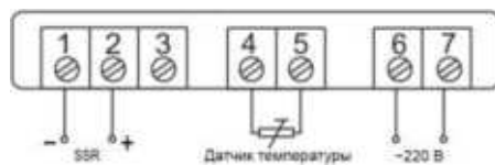
Рис. 3 – Схема подключения. SSR – управление твердотельным реле
