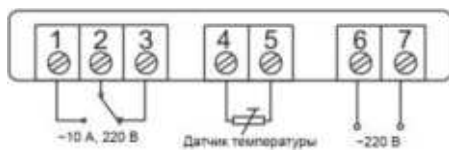
Рис. 2 – Схема подключения. Реле ~10 А, 250 В
