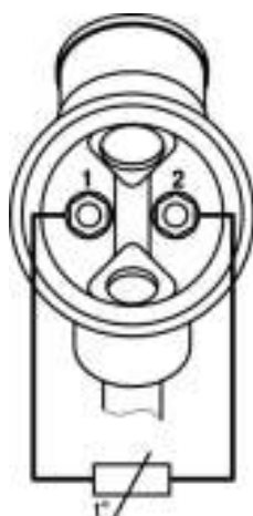
Рисунок Д.8 – Двухпроводная схема подключения проводов к клеммам пластмассовой коммутационной головки с одним ЧЭ
