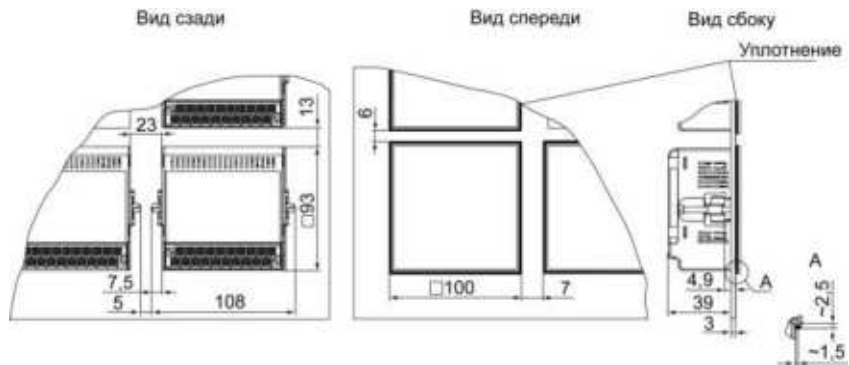
Рисунок 4.5 – Прибор в корпусе Щ11, установленный в щит толщиной 3 мм
